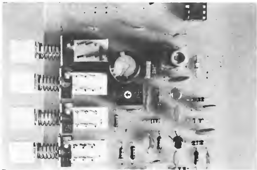
Fig. 6.6 Fotografia dei primi due stadi a FI. L'utilizzo di filtri ceramici consente di ridurre la taratura al solo trasformatore di ingresso.
